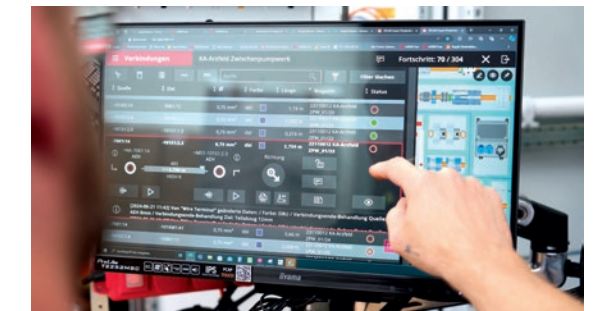
Das Assistenzsystem Eplan Smart Wiring visualisiert Montageaufbau, Betriebsmittel, Verbindungen und Verlegewege und führt durch den Verdrahtungsprozess.
